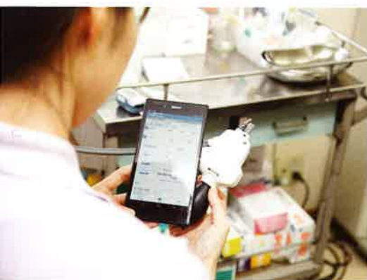
対応した血圧計や体温計にスマートフォンをかざすと計測データは手間なく取得・アップロードできる。
